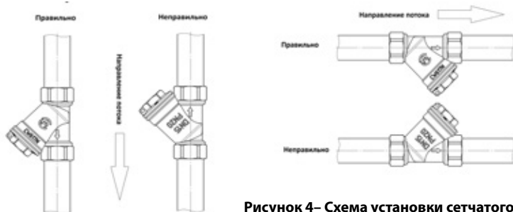
Рисунок 4– Схема установки сетчатого фильтра
